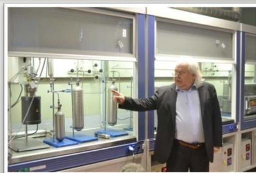
**Создана демонстрационная установка позволяющая перевести платиновые металлы в газофазное состояние, в непрерывном режиме разделить их и нанести в индивидуальном виде или в заданном составе на носитель с строго заданными размерами частиц от 10 nm до сплошного металлического покрытия.**
